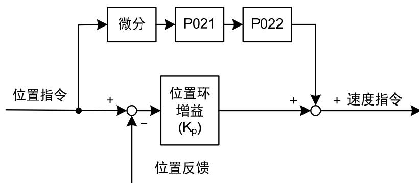
前馈能降低位置环控制的相位滞后，可减小位置控制时的位置跟踪误差以及更短的定位时间。前馈量增大，位置控制跟踪误差减小，但过大会使系统不稳定、超调。若电子齿轮比大于10也容易产生噪声。一般应用可设置P021为0%，需要高响应、低跟踪误差时，可适当增加，不宜超过80%，同时可能需要调整位置环前馈滤波时间常数(参数P022)。
