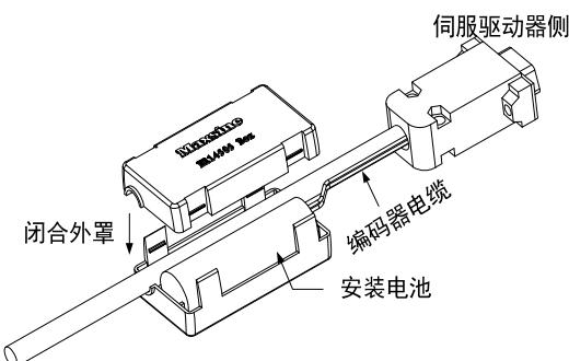
**注意：请勿在伺服驱动器两侧都设置电池单元。电池单元请设置在伺服驱动器的任意一侧。**
