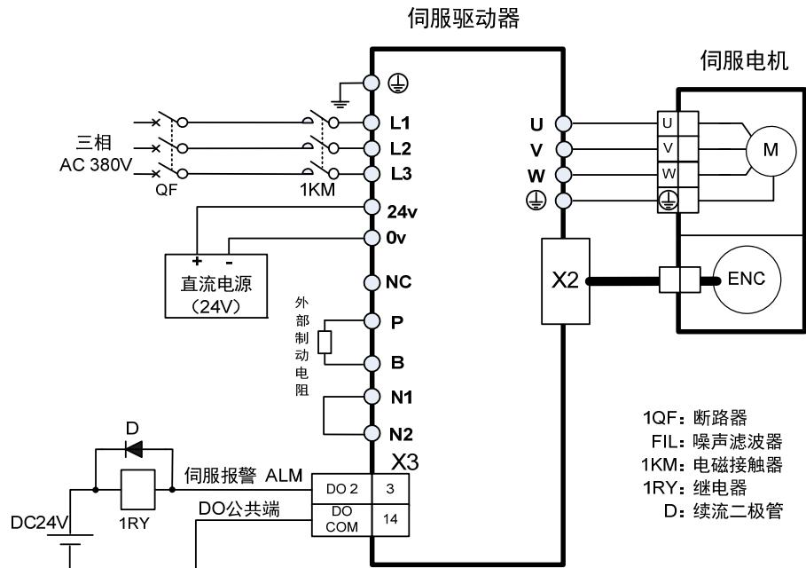
注：TH50、TH75 无内部制动电阻，需连接外部制动电阻使用。
