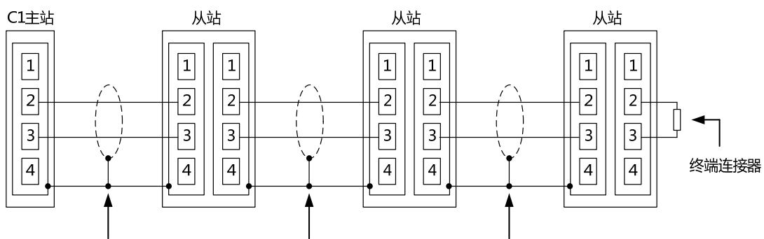
为减弱终端部分的信号反射，网络两端均需连接终端连接器，在 C1 主站内置终端电阻时，终端连接器只能连接到网络的另一端，上图是 C1 主站内置终端连接器时的连接图。
