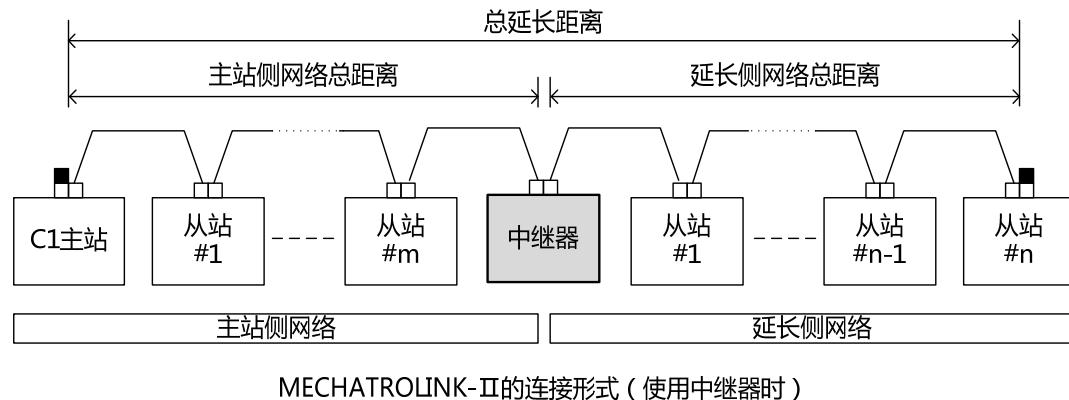
连接中继器后，配线按照如下标准，在单个 Mechatrolink-II 系统中，最多设置 1 台中继器。站间距离是指相邻站之间电缆的长度。配线时，请保证站间距离大于 0.5m，连接到中继器的电缆也请与其他从站一样，确保 0.5m 以上的站间距离。
